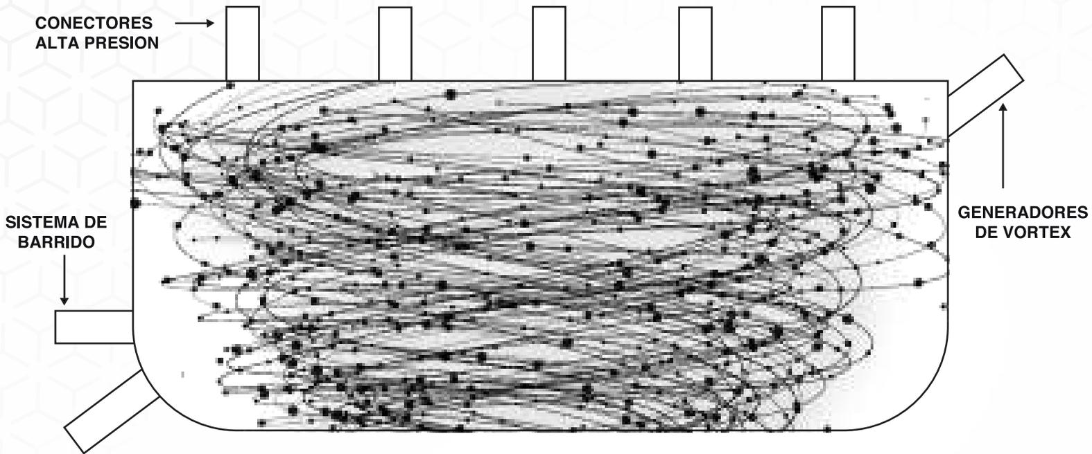
Una línea de aire alimenta el sistema de alta presión y filtros de eliminador de olores, micronicos y submicronicos pasando por una serie de electroválvulas, activadas por alta potencia de aire y vacío secuencial de manera que generan un vortex en el interior de la mezcladora, logrando su limpieza en 3 ciclos de 30 segundos cada uno.
